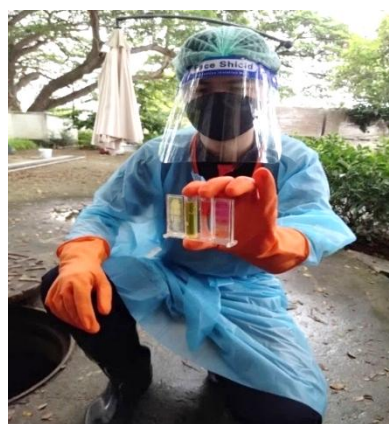
รูปที่ 3.5-3 การเก็บตัวอย่างน้ำเพื่อตรวจสอบประสิทธิภาพระบบบำบัดน้ำเสีย
